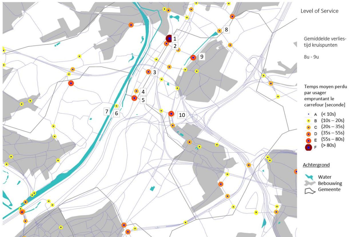
Figure 28 : Niveaux de service dans le scénario S2
