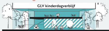
SCHEMA 2 – Inplanting van dubbele hoogte in de voorzieningen van het type kinderdagverblijf, met wintertuinen
