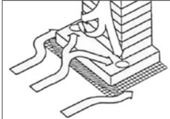
Figure 285 : Effet de protection lié à l'implantation d'un socle (Advanced Environmental Wind Engineering, Yukio Tamura, 2016)
