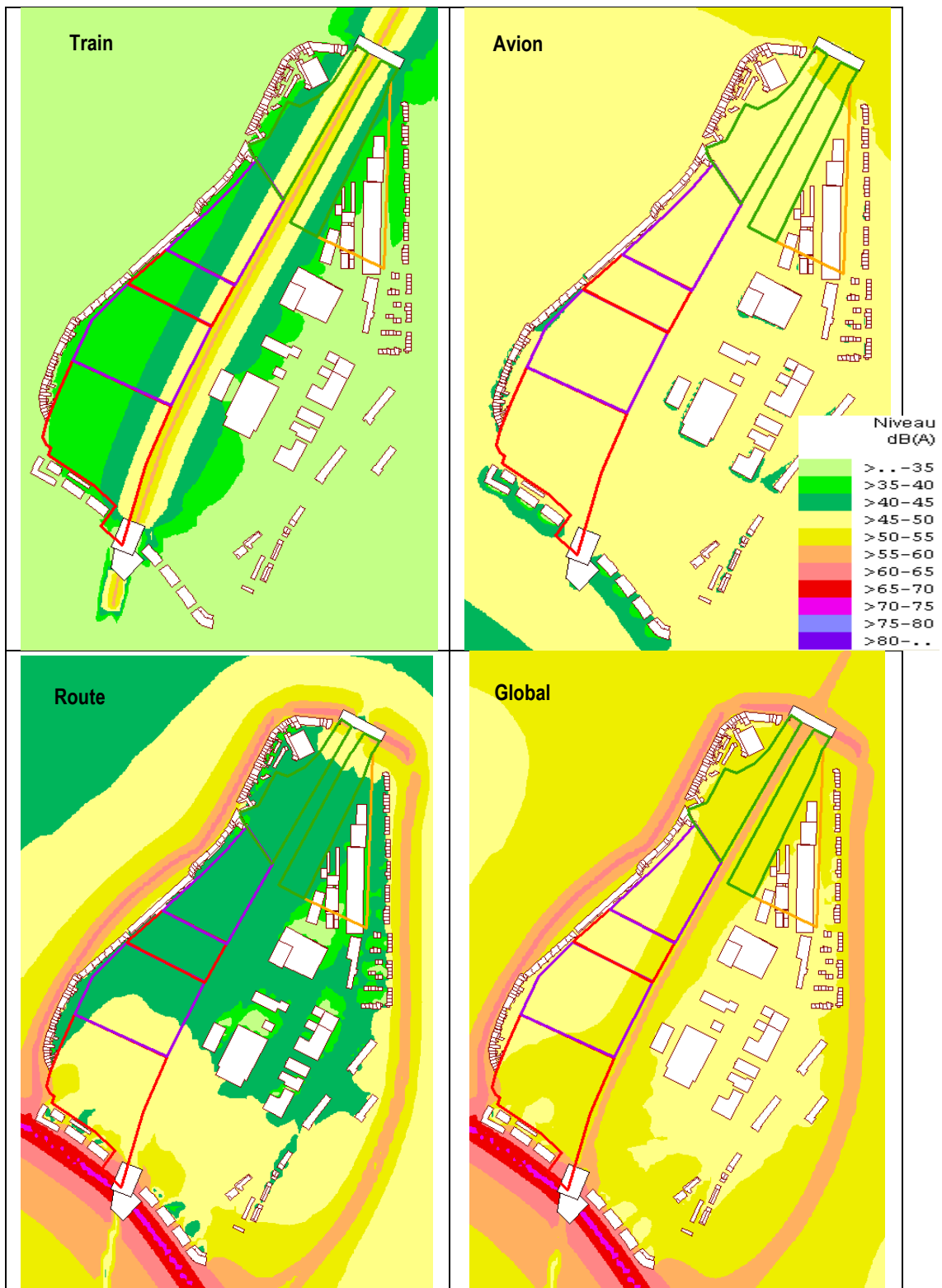
Figure 177 : Modélisation de la situation existante - niveau de nuit (ARIES, 2015)
