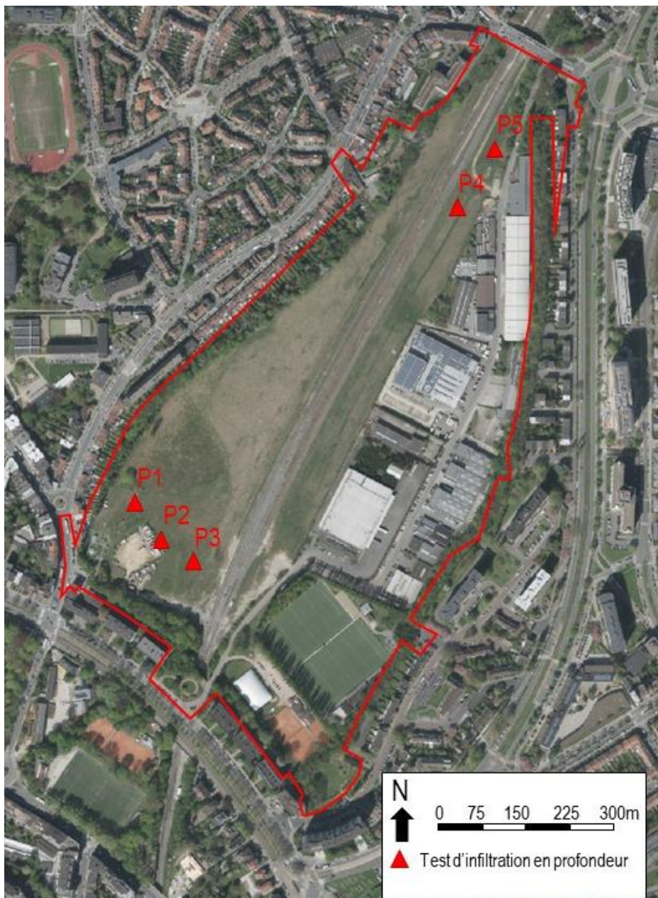
Figure 132 : Localisation des points de mesure de la vitesse d'infiltration en profondeur (ARIES, 2015)
