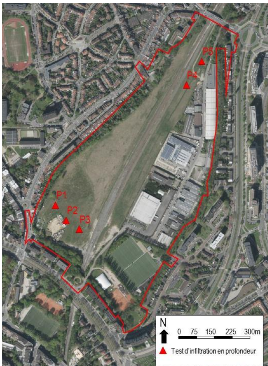
Figure 144 : Localisation des points de mesure de la vitesse d'infiltration en profondeur (ARIES, 2015)
