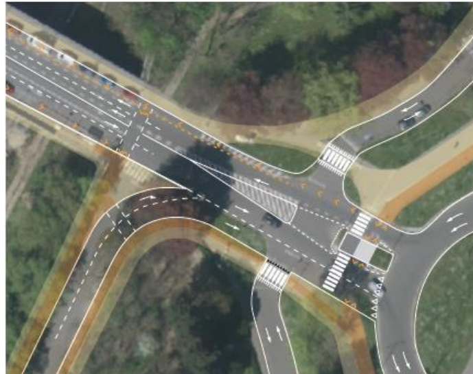
Figure 331 : Schéma de configuration de l'accès au rond-point du boulevard Léopold III
