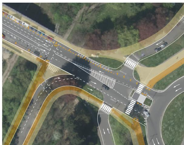
Figure 32: Schéma de configuration de l'accès au rond-point du boulevard Léopold III
