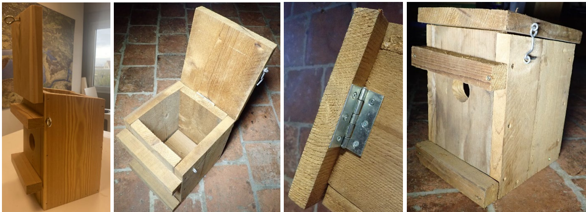
Van links naar rechts: nestkast van geschaafd lorkenhout met scharnier aan de achterzijde (© Ecovery), nestkast van Thermowood met scharnier aan de voorzijde, close-up van scharnier aan de voorzijde, sluiting met haakje en oogvijs.
