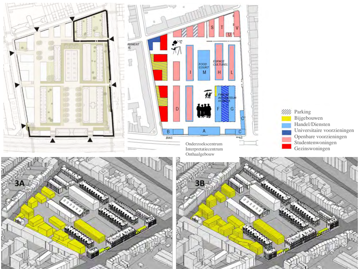
Figuur 11: Inplanting en bouwprofielen van de nieuwe constructies Scenario 3 (BUUR, 2017)
