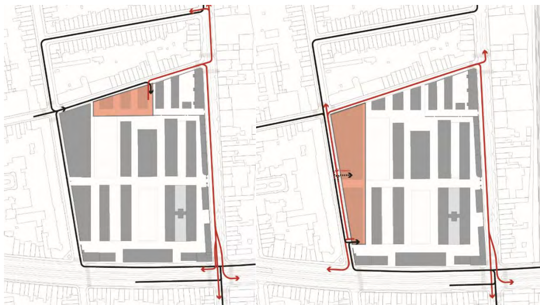
Figuur 7: Voorgestelde configuratie voor de ondergrondse parkings en hun toegangen (BUUR, 2018)
