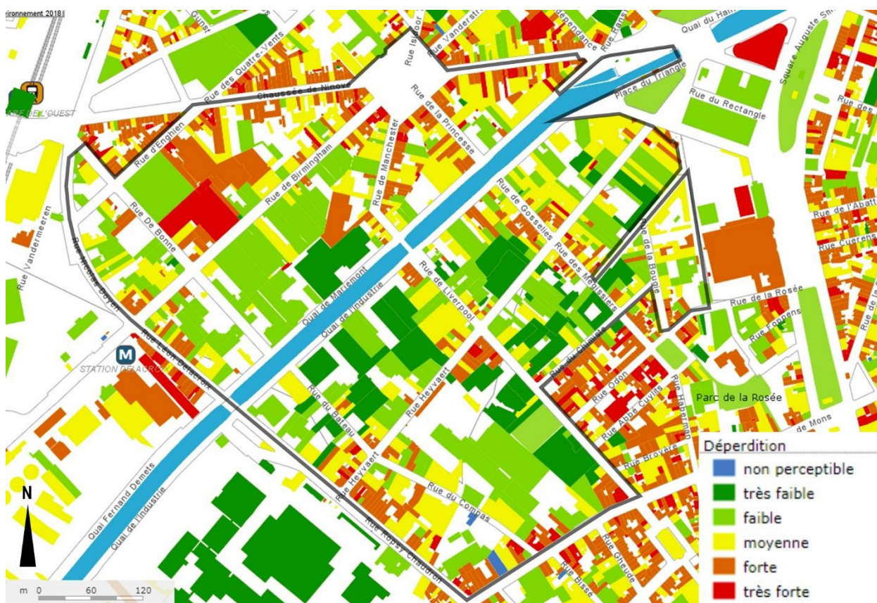
Figure 74 : Thermographie aérienne au niveau du quartier Heyvaert (source : Bruxelles Environnement)
