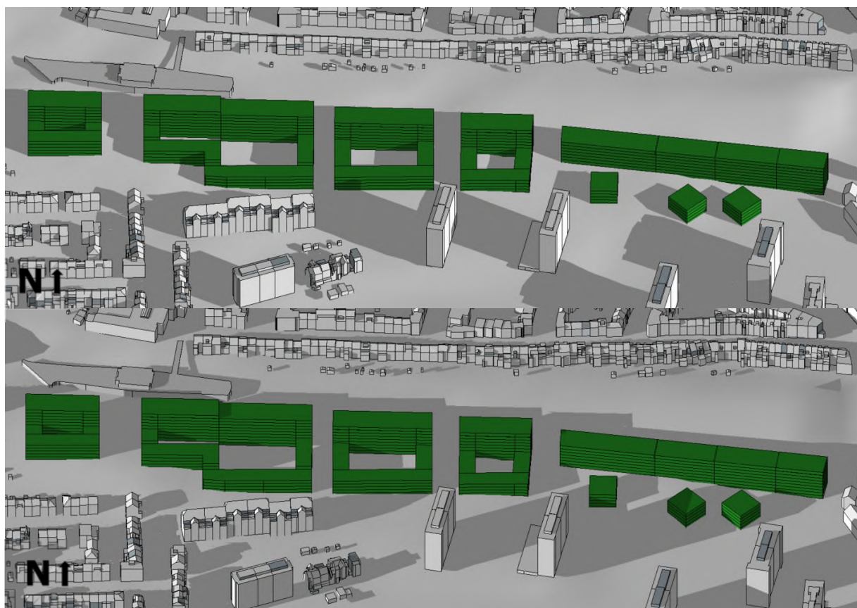
Figure 1051 : Ombrage sur les bâtiments du site Beaulieu aux équinoxes à 9h (en haut) et à 17h (en bas) (ARIES, 2018)
