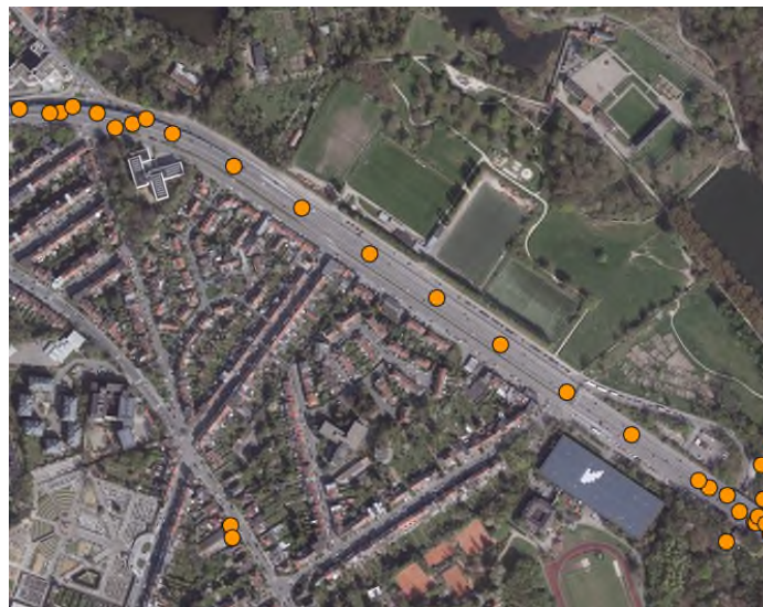
Figure 469 : Sondages dans Databank Ondergrond Vlaanderen à hauteur du site stade-Adeps (Databank Ondergrond Vlaanderen, 1966-1971)
