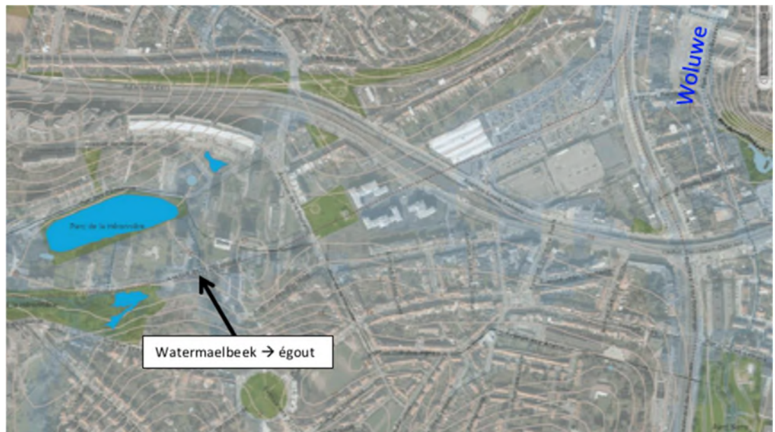
Figure 320: Connexion du Watermaelbeek à l'égout (IBGE, Note E411 – Entrée en Ville du carrefour Léonard à Delta, 2016)
