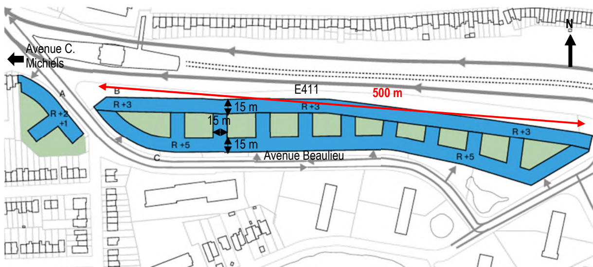
Figure 548 : Implantation et gabarits sur le site Beaulieu (ORG 2 , 2018)
