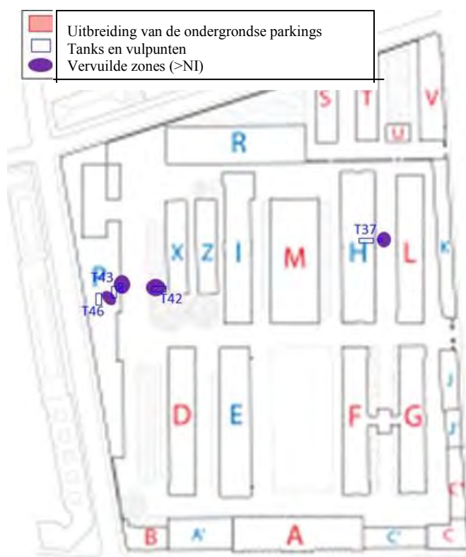
Figuur 65: Lokalisering van de verontreinigde zones op de sites (ARIES Consultants volgens de Bodemkundige Dienst van België, 2017)
