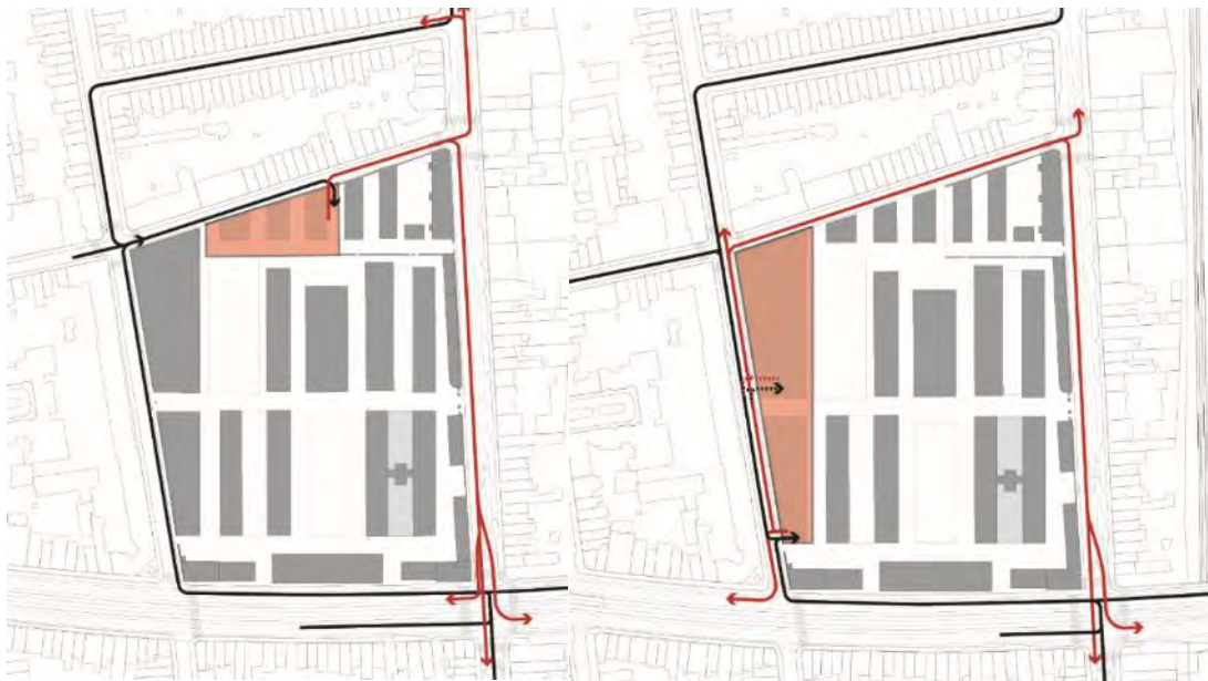
Figuur 160: Voorgestelde configuratie voor de ondergrondse parkings en hun toegangen (BUUR, juni 2018)
