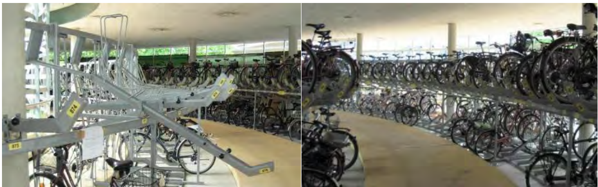
Figuur 171: Principe van een fietsenstalling op twee niveaus ( http://velorutionlyon.free.fr/ )
