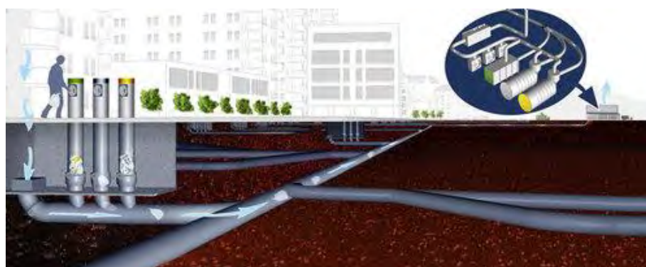
Figuur 331: Ondergrondse schematische voorstelling van een geautomatiseerd pneumatisch inzamelingssysteem. Bron: Association internationale des tunnels et de l'espace souterrain, 2015.
